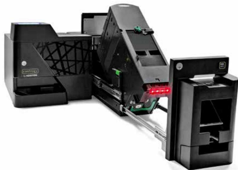
Modulo banconote basculante e modulo monete estraibile per un accesso **semplice** e **rapido** alle componenti interne del dispositivo ai fini della manutenzione.
